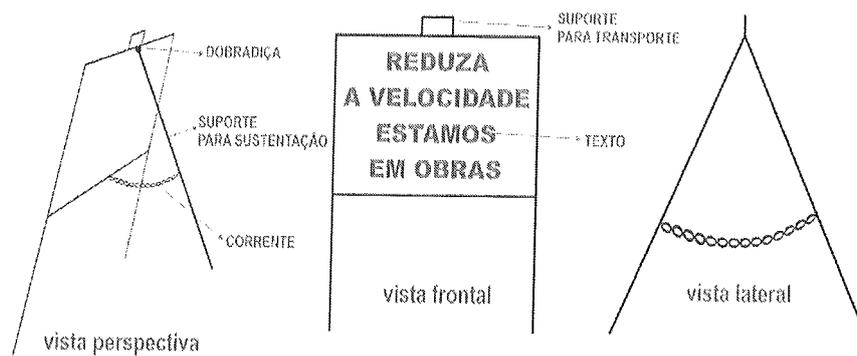
Figura 3: Cavalete em chapa galvanizada.
