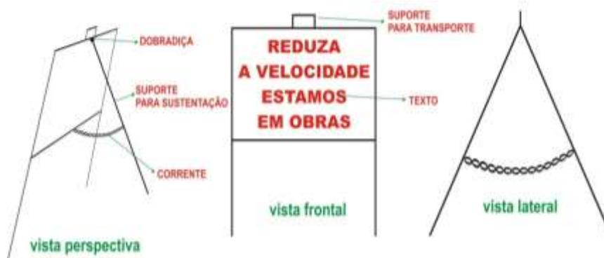
Figura 3: Cavalete em chapa galvanizada.
