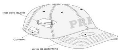
Figura 2 - Vista dos detalhes internos do Boné
