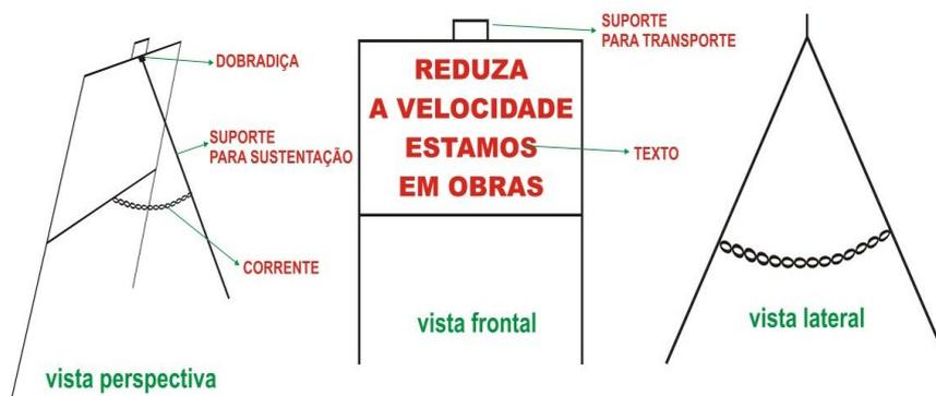
Figura 3: Cavalete em chapa galvanizada.
